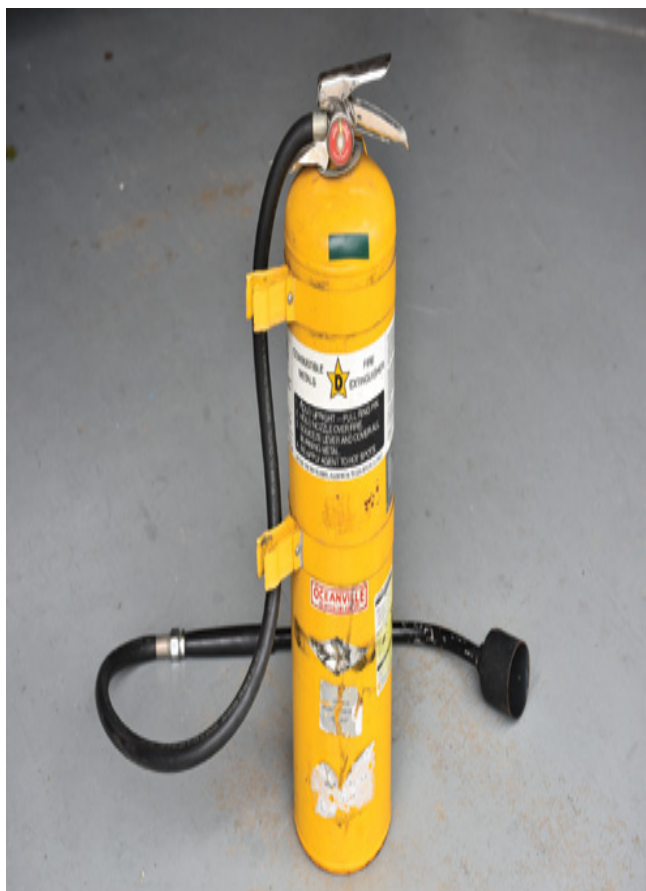
شکل ۲۳-۲ خاموش کننده های حریق پودر خشک به راحتی با سیلندر زرد رنگشان شناسایی می شوند.
