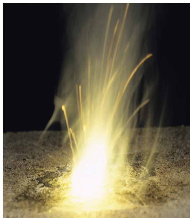
شکل ۸-۲ فلزات قابل احتراق در حریق های کلاس D به مواد خاموش کننده خاصی نیاز دارند.
