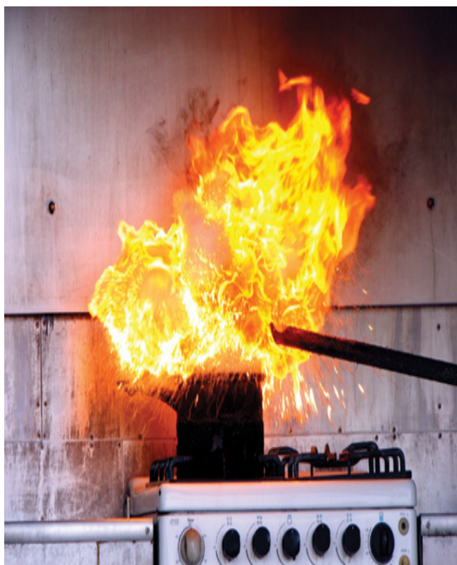
شکل ۹-۲ حریق های کلاس K شامل روغن ها و چربی های قابل احتراق پخت و پز.
