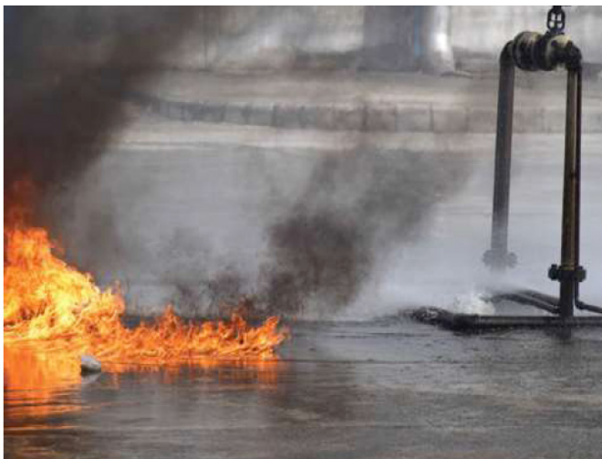
شکل ۱۱-۱ آتش کلاس B شامل مایعات قابل اشتعال است مانند بنزین است.
